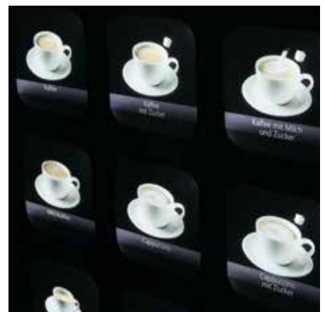
Ansprechende große kapazitive Tasten hinter einer vollflächigen Glasscheibe
